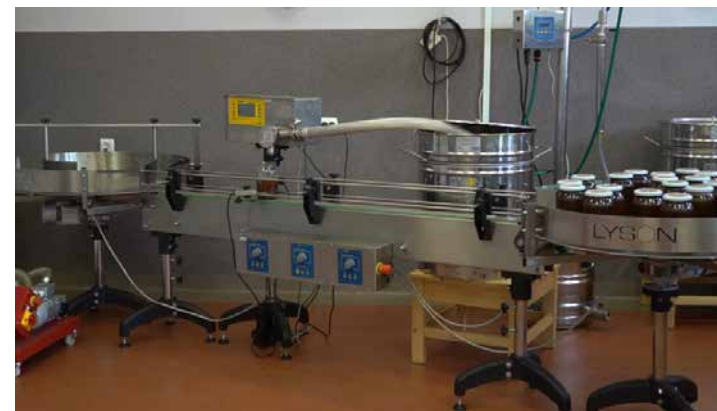
Fot. 13 Automatyczna linia do rozlewu miodu
