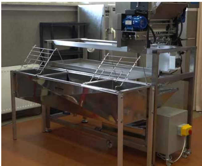
Fot. 14 Stół oraz automatyczna odsklepiarka do ramek
