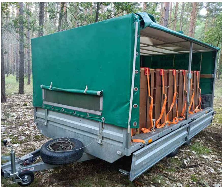
Fot. 39 Zabezpieczanie uli do transportu
